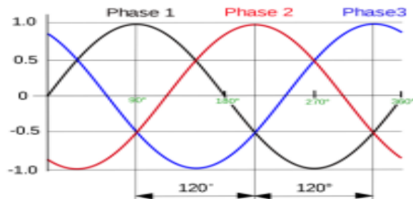
<정상 동작 상태에서의 3상 전압 파형(예시)>
