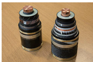
그림 4 영국-벨기에 포설된 HVDC 400kV 케이블 [12]
