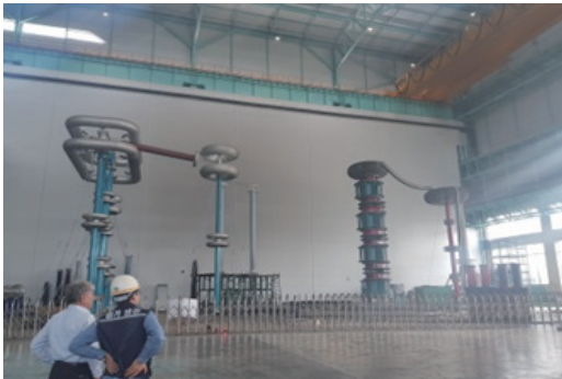
(a) 500kV급 MI-PPLP Type test 선로
