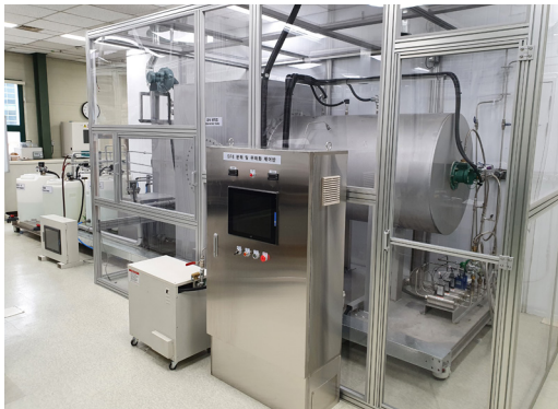
그림 4 파일럿급(10kg/일) SF 6 분해 및 무해화 시스템
