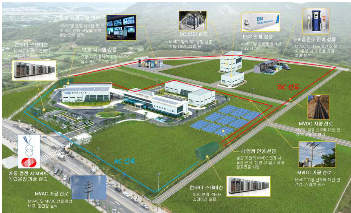
그림 4 MVDC 배전망 파일럿 플랜트 구축 개념도
