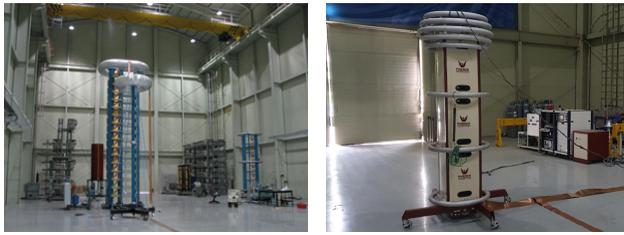
(a) 1600kV 뇌임펄스시험설비 (b) DC 600kV 내압기
