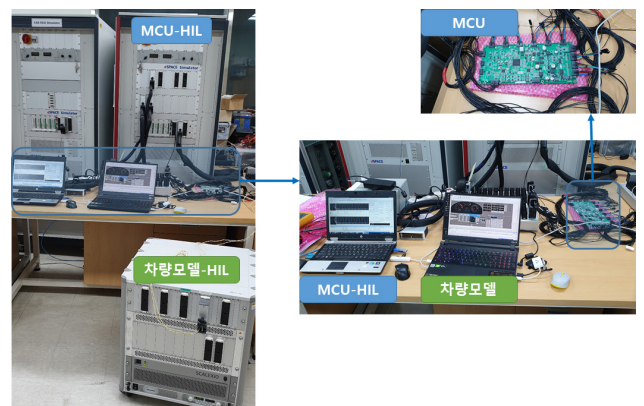
그림 4 MCU HIL 테스트 환경 구축
