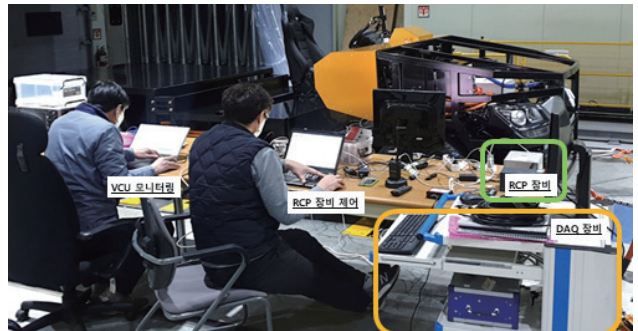
그림 9 플랫폼 차량의 차대동력기 시험 및 모니터링 환경
