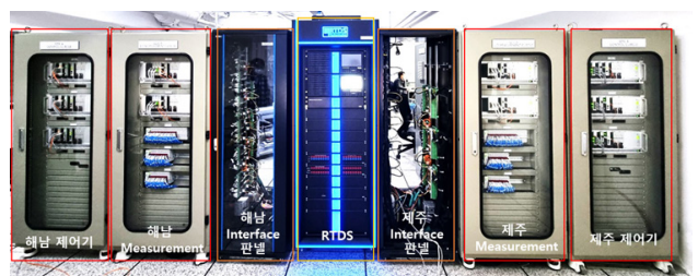
그림 1 HILS 기반 제주 #1 HVDC 제어 성능 검증 플랫폼 H/W
